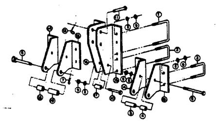
7' DRILL 3<sup>PT</sup> HITCH ASSEMBLY NO:522087
